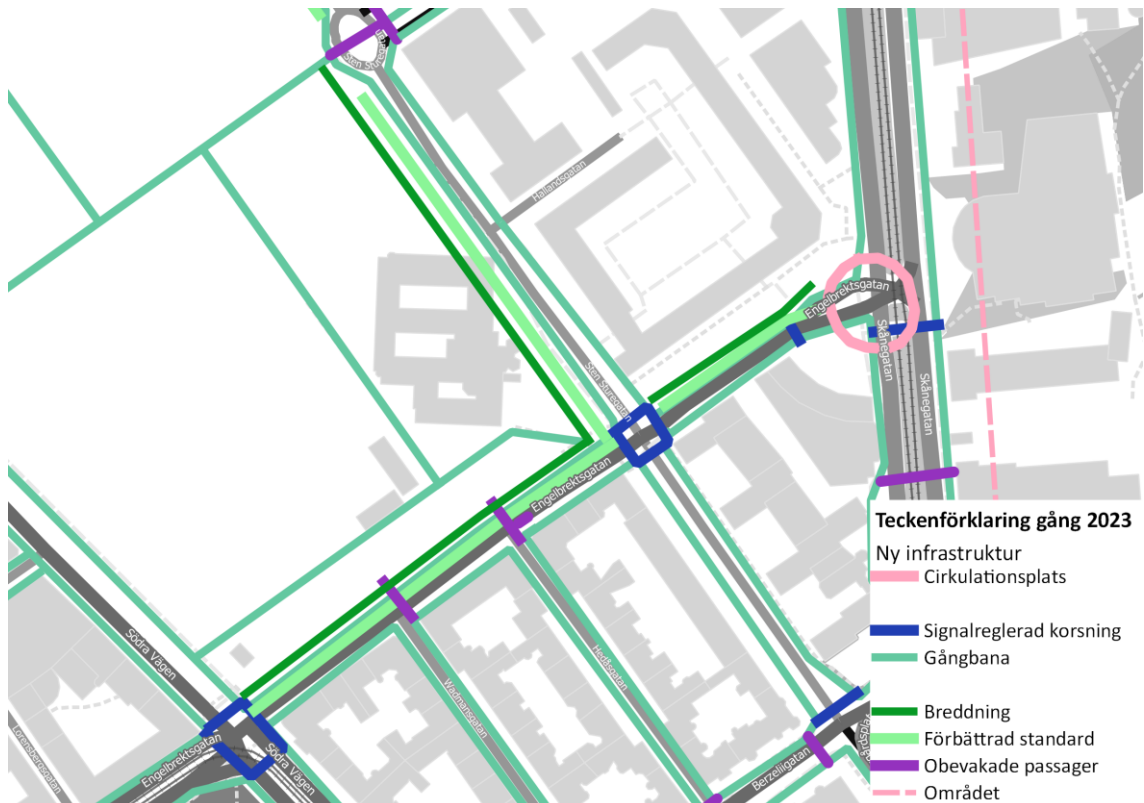
Figur 3-3 Karta över Engelbrektsgatan som visar infrastrukturen samt förändringar av infrastrukturen för gång, färdig byggnation © OpenStreetMap bidragsgivare
